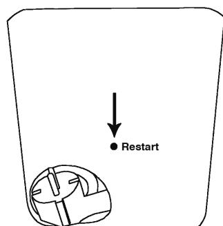
Ved overophedning vil det termiske sikkerhedssystem slukke gryden automatisk. Dette sikkerhedssystem findes på bagsiden af den elektriske del. Hvis det er blevet slukket, kan der tændes igen ved at trykke på knappen med en lang, spids genstand. Knappen sidder helt inde bag i hullet, så brug til dette formål den vedlagte genstart-stift. Før dette gøres, tages stikket ud af kontakten!
