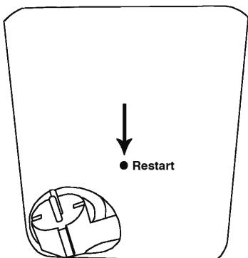
En cas de surchauffe, la protection thermique permet de déconnecter la friteuse. Ce dispositif de sécurité se trouve sous la partie électrique. Si la protection thermique est déconnectée, vous pouvez la remettre en route en appuyant sur le petit bouton à l'aide d'un objet pointu. Ce petit bouton est enfoncé profondément dans le trou, vous devrez donc utiliser la tige fournie. Débranchez toujours l'appareil de la prise avant !
