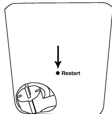
Bei Überhitzung schaltet die thermische Sicherung den Topf aus.
